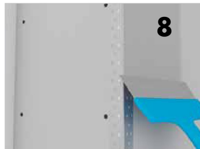
8. Hjørnebeskytter spartles på samme vis som gipspladerne. Vi anbefaler minimum 300 mm bred spartling ud fra hjørnebeskytteren. Ønskes samlingerne spartlet til en plan flade anvendes Knauf Uniflott. Forbrug ca. 300 g/m 2 .
